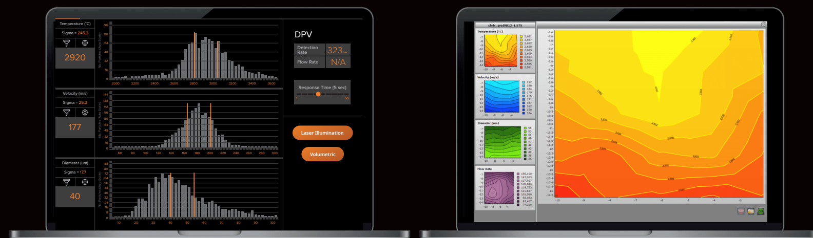
将速度和温度与粒子大小关联起来，以优化喷涂参数
